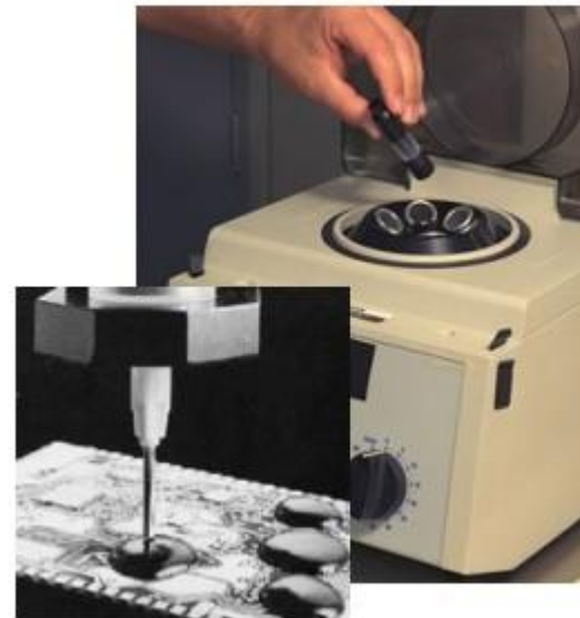
Центробежная машина для удаления пузырьков воздуха из защитного состава
